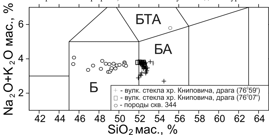
Рис. 2. Составы вулканических стекол и интрузивных пород скв. 344, хр. Книповича на классификационной диаграмме \text{SiO}_2 - (\text{Na}_2\text{O} + \text{K}_2\text{O}) .
