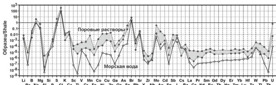
Рисунок 2. Сравнение содержания элементов в ПР донных отложений оз. Солёное (область указывает на разброс значений от min до max) с содержанием элементов в морской воде [13], нормированные на содержания в сланце (Shale) [13].
