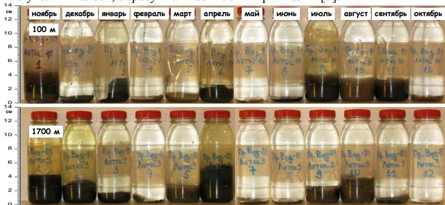
Рисунок 2. Фотографическое изображение пробосборников седиментационных ловушек «Лотос-3», характеризующее сезонную изменчивость вертикального потока осадочного вещества.
