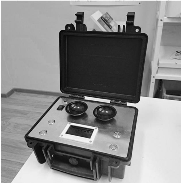
Рисунок. Внешний вид разработанных цифровых весов.
