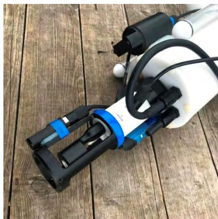
Рисунок 2. Океанологические датчики профилографа Winchi (см. текст)
