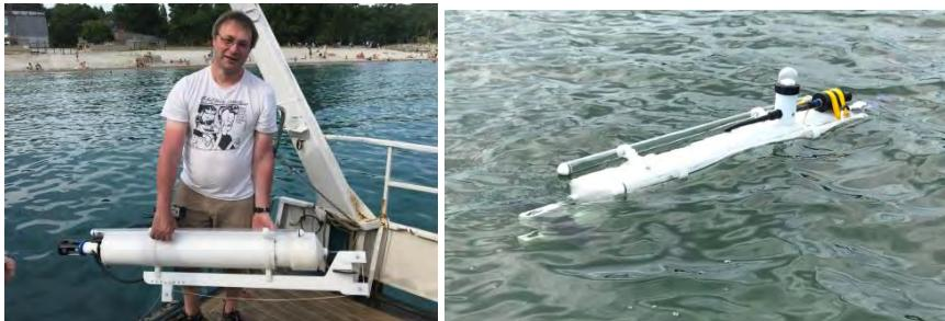
Рисунок 1. Автономный заякоренный профилограф Winchi
