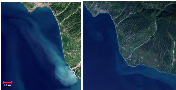
Рисунок 1. Спутниковые изображения видимого диапазона MSI Sentinel 2-A от 10.09.2017 при интенсивном речном стоке (слева) и от 08.10.2018 при малом стоке (справа). В зависимости от течений в море взвесь разносится над шельфом в разных направлениях.
