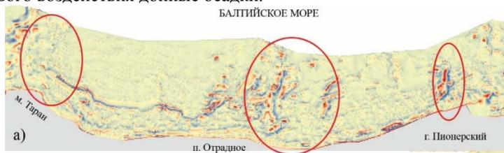
Рис. 2. Рассчитанная кривизна поверхности для используемой цифровой модели рельефа для Светлогорской бухты (от мыса Таран до г. Пионерский)
